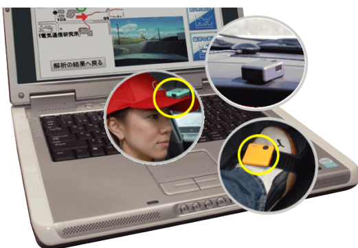
GPS+3個のセンサー+PCの連動により 運転技能を測定
