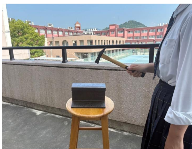
鉄道レールを再利用し完成した「アンビル」
