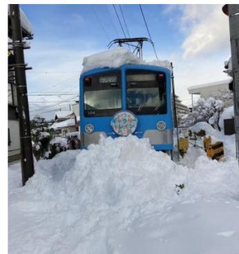
推定原因：車体の床下及び台車の周辺に大量の雪を抱き込んだ状態で走行していたため、踏切上にあった圧雪に乗り上げたことが原因と考えております。また、踏切のレール部と踏切床板との隙間（フランジウェイ）部分の圧雪も脱線に影響した可能性があります。
