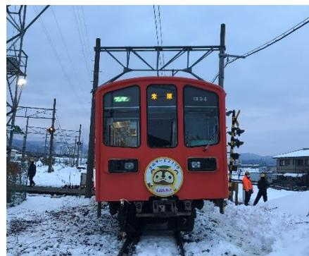
推定原因：マクラギとレールを固定する器具に緩みや破損がある状態で列車が通過したため、通過した際に車両の重みがかかりレールとレールの間隔が広がり脱線しました。
