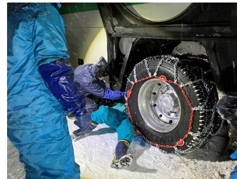
実技研修の様子（チェーン脱着訓練）
