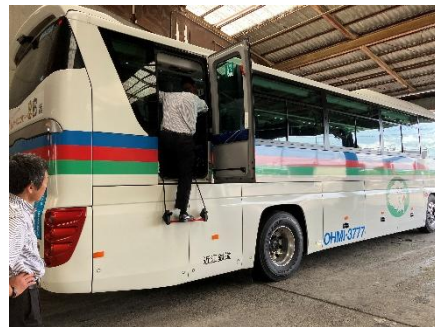
車両点検、非常口の取扱いの様子
