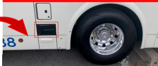
左後輪の前部に装着された「ミリ派レーダー」により、車両左側の歩行者・自転車・車両等の急な進入を感知し、ドライバーに警告。
