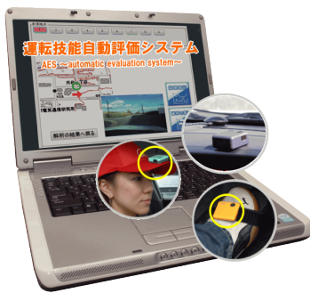
GPS+3 個のセンサ+PC の連動により 運転技能を測定
