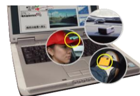
GPS+3個のセンサー+PCの連動により運転技能を測定
